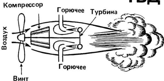
ТВД конструктивно очень похож на ТРД, однако значительная часть мощности турбины расходуется на вращение не только компрессора, но и воздушного винта.
