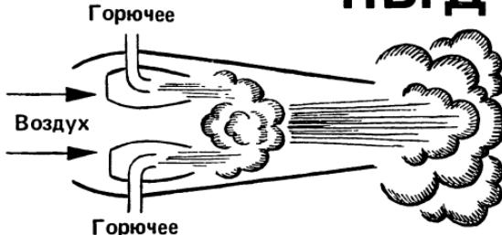
Всем хороша схема ПВРД — прямоточного воздушно-реактивного двигателя: масса невелика, и конструктивно ПВРД прост, и много других плюсов. Одна беда — для того чтобы двигатель заработал, ему надо придать значительную начальную скорость. Иначе в камеры сгорания воздух не поступит или его поступит слишком мало. А если не хватит воздуха — горения не будет.
